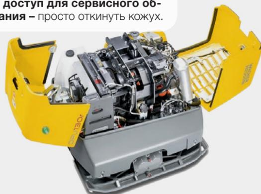
**Низкорамный прицеп больше не нужен:** модель DPU130r весит всего 1200 кг и может транспортироваться на кузове грузовика.
