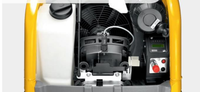
Краткий обзор: светодиодные лампочки системы контроля уплотнения Compatec показывают степень уплотнения.
