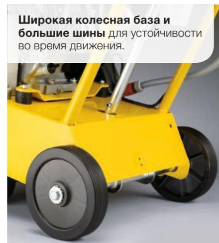
**Надежность в использовании:** высокопрочная рама обеспечивает высокую точность держания колеи.
